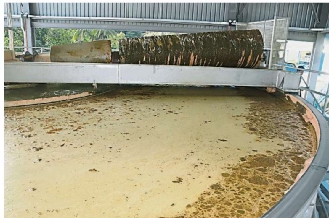
溶氣氣浮濾水廠安裝一個掃除污垢器，從水壩抽上來的水分解後沙石會沉澱。
